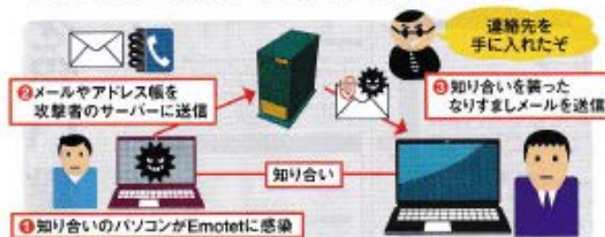
図9 Emotetに感染したパソコンから連絡先やメールの文面を盗み、それらを悪用して偽のメールをばらまく【注2】。Office文書だけでなく、パスワード付きのZIPファイルやショートカットファイル、PDFを添付したり、URLのリンク先からダウンロードさせたりするパターンもある
